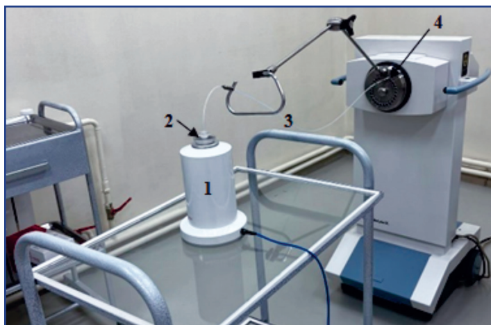
1 – ұңғыма тәріздес камера; 2 – адаптер; 3 – стандартты катетер; 4 – quick-коннектор Сурет 1 – GammamedPlus HDR (Ir-192) брахитерапиялық құрылғысы мен ұңғыма тәріздес иондаушы камера «Sourcecheck 4л. - SN 122350»
